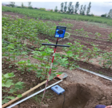
2-rasm. Namlik sensori: Tuproq namligini o'lchash DHT11 namlik sensori, pH sensori,.
